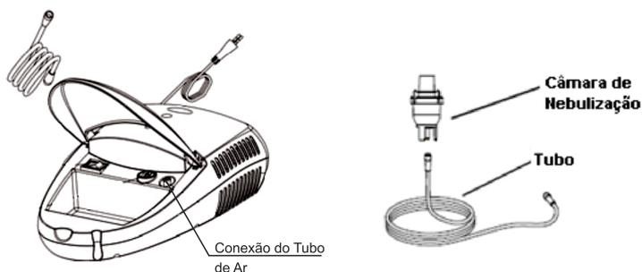
7-Conecte na parte superior da câmara de nebulização a máscara de nebulização ou ao acessório bucal (peça opcional) (E). O encaixe dos acessórios com a tampa da câmara de nebulização são projetados para encaixar sem folga.
