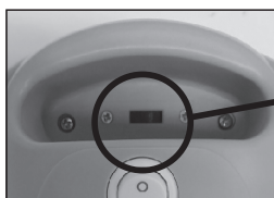
Localização da chave seletora de voltagem
