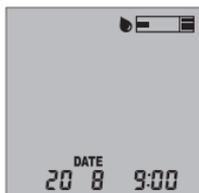
Uma tira de teste piscando aparece no topo da tela do display, indicando que o medidor está pronto para o teste.
