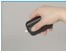
1. Uma vez que o teste for concluído, empurre o botão do ejetor para frente para remover a tira reagente do medidor.
