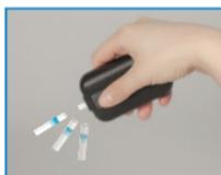
Uma vez que o teste estiver concluído, empurrar para a frente o botão de ejeção para remover a tira de teste do medidor glicose no sangue.
