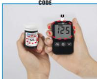
Quando você insere a tira reagente de glicose no medidor, o comando ajusta automaticamente o medidor de acordo.
