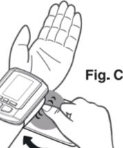
4 - Se a braçadeira não ficar segura o suficiente em torno do pulso, conforme ilustrado na figura C, o valor da medição pode ser incorreto.
